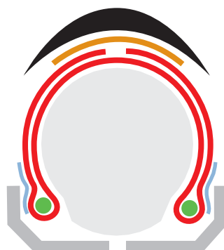
Reifenaufbau im Schnittmodell
